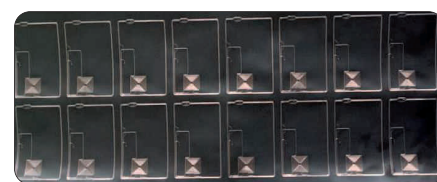
Obr. 3. Nahé antény pred procesom kompletovania – súbor antén z produkcie Muehlbauer Technologies, s. r. o., Nitra.
