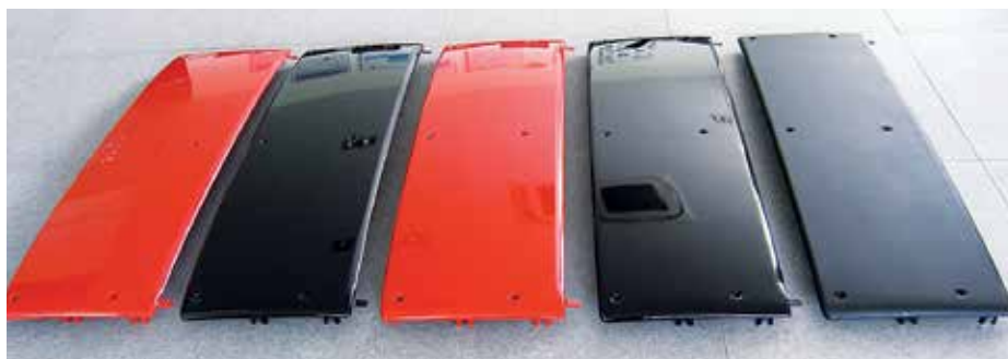
Kryt strechy luxusného kabrioletu z penového hliníka, foto ÚMMS SAV
