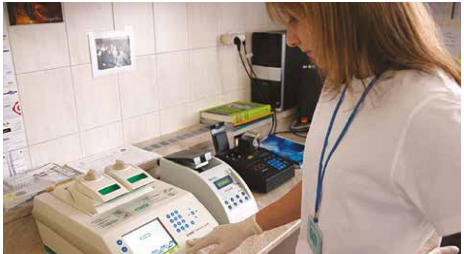
Termocyklér – prístroj na množenie genetického materiálu na jeho detekciu alebo ďalší výskum, foto autor
