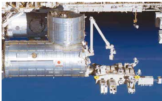
Misia využila vonkajšiu výskumnú plošinu EFU (vpravo) pripojenú k japonskému modulu ISS Kibō (vľavo), foto JAXA/NASA.
