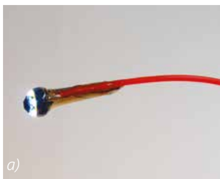
Na snímke je a) priamy a b) retrográdny model USB kapsulového endoskopu.
