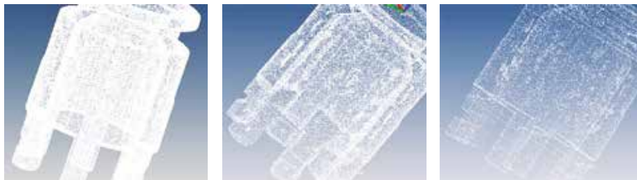
Mračno bodov tvoriace 3D model (rôzny počet bodov)
