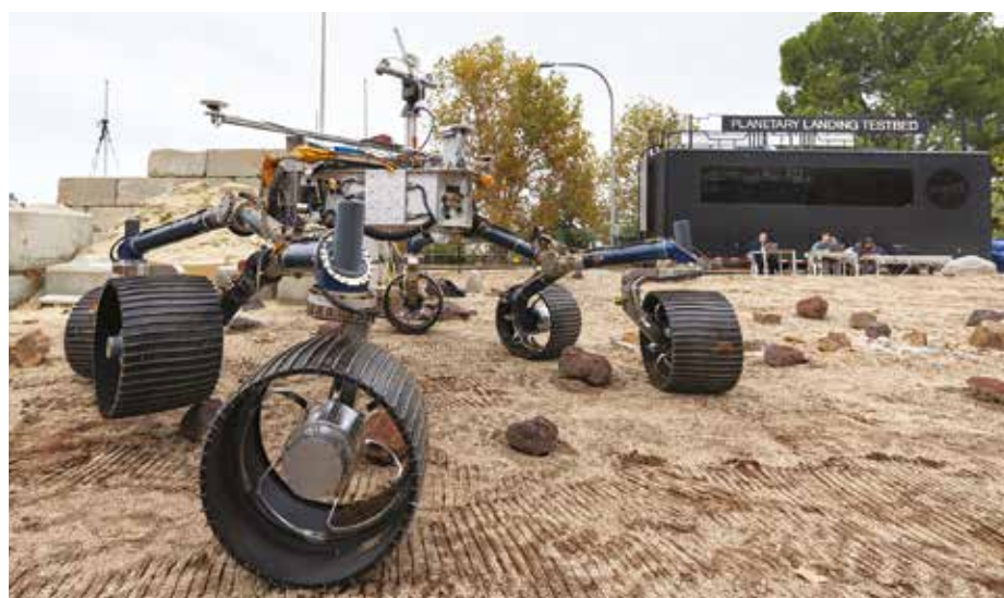
Testovanie jazdných vlastností Perseverance na tzv. martánskom dvore, ktorý simuluje povrchové podmienky na Marse v areáli JPL v kalifornskej Pasadene, foto NASA/JPL-Caltech
