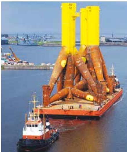
Trojnožky podstavce pre morské veterné turbíny vo Wilhelmshaven v Nemecku, foto wikipédia/DOTI Jan Oelker
