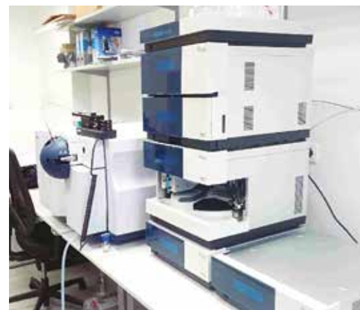
Nanokvapalinový chromatograf s hmotnostným spektrometrom využívaný na proteomické analýzy
